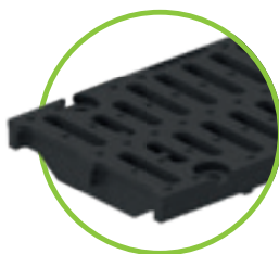
Grătar din fontă SW 15/75 – clasă de sarcini F 900, Înșurubare în 4 puncte, pentru LN 150
