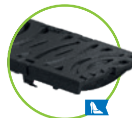
grătar din fontă cu design special VILLE, clasă de sarcini E 600, SW 7 de la LN 100 la 200
