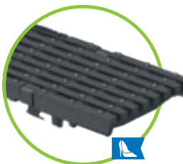
Grătar din fontă cu nervuri longitudinale MW 29/6, clasă de sarcini C 250, SW îngust, protecție tocuri pentru LN 100
