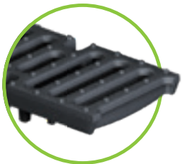
Grătar nervurat din fontă SW 14/100, 14/150, 14/200 pentru LN 100 până la 200 clasă de sarcini E 600, cu fiX-locking de la LN 100 la 200 clasă de sarcini D 400 înșurubare în 4 puncte
