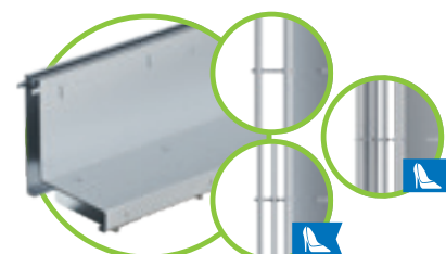
Grătar fantă SW 12,5 mm, clasă de sarcini B 125, LN 100, oțel zincat și innox SW 12,5 mm, clasă de sarcini C 250, LN 100 / 150, oțel zincat și innox 2S, SW 2x6 mm, clasă de sarcini B 125 LN 100, innox 2S, SW 2x6 mm clasă de sarcini C 250, LN 100 / 150, oțel zincat și innox 3S, SW 3x6 mm clasă de sarcini C 250, LN 100 / 150, innox
