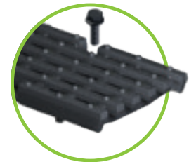
grătar din fontă cu nervuri longitudinale MW 29/13– LN 100 & 150 MW 25/13 – LN 150, până la clasă D 400 MW 22/13 – LN 150 & 200, până la clasă E 600 Înșurubare în 4 puncte (doar pentru muchia din fontă)
