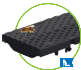
Grătar COMBee Ø 7,3 mm, clasă de sarcini B 125 și C 250 plastic PA6 pentru LN 100
