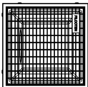
Avaloir ponctuel avec grille caillebotis ou grille en fonte ductile cl.B125kN, incl. panier à sédiment et trappe à odeurs
