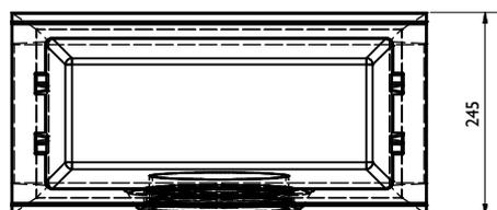
élément de sortie - partie inférieure DN200
