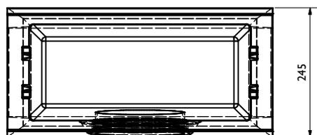
panier à sédiment (optionnel pour élément de sortie)
