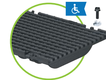
11. Grille longitudinale en fonte ductile MW 1,14" x 0,51" (29x13 mm) cl. D or cl. E 4 points boulonnés
