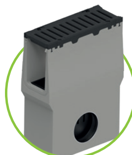
Zandvangelement eendelig incl. gietijzeren rooster, vuilvangemmer, uitloop DN 150
