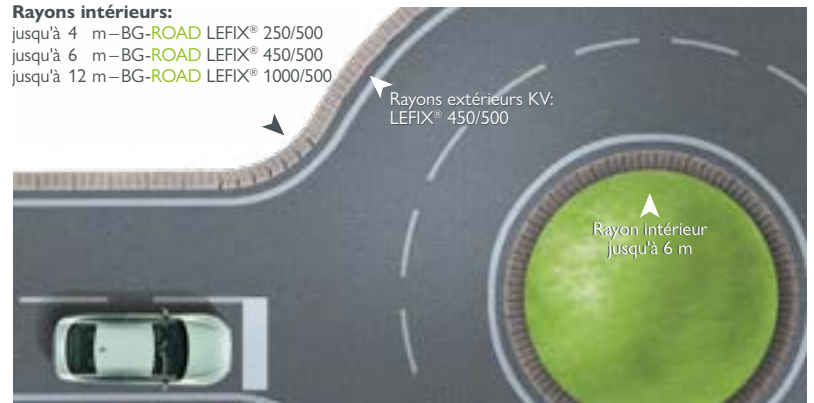
Exemple de pose: Rond-point avec différents rayons
