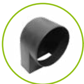
Trappe à odeurs pour puisard DN 100/150 Montage : Insérer la trappe à odeurs à l'intérieur du puisard et la raccorder à la canalisation par l'extérieur.
