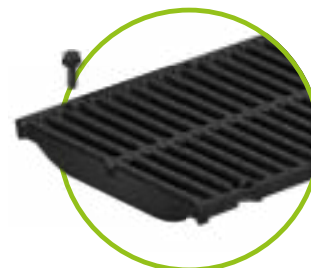
Grille à fentes en fonte ductile LF 18/215, Cl. E boulonnées en 4 points
