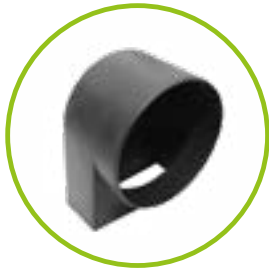
Trappe à odeurs pour puisard (interne) DN 100/150 Installation : Insérer la trappe à odeurs à l'intérieur du puisard et la raccorder à la canalisation par l'extérieur.
