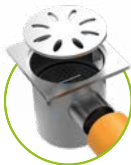
omega Unités d'écoulement avec trappe à odeurs et panier à sédiment, pour sortie horizontale
