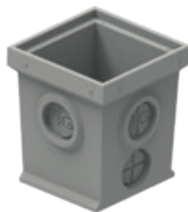
BG-FILCOTEN ® spot-p pompput uit FILCOTEN ® HPC met uitsparing (Ø 138 mm) voor een Forsheda-dichting DN 100
