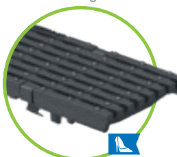
Gietijzeren langsstaafrooster MW 29/6, kl. C, nauwe spleetbreedte voor NW 100
