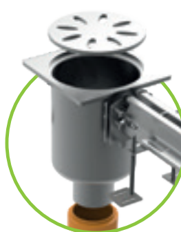
omega afvoerelementen incl. stankafsluiter en vuilvangemmer, verticale uitloop
