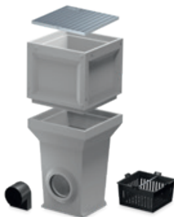
spot met mazenrooster, auto berijdbaar, incl. stankafsluiter en vuilvangemmer, opzetelement optioneel
