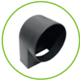
Stankafsluiter voor zandvangelement voor retrofit DN 100/150 Inbouw: de stankafsluiter binnen in het zandvangelement plaatsen en met de rioolbuis van buitenaf ineensteken.
