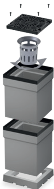
Regard de contrôle spot HD inspect cadre et grille en fonte incl., panier à sédiment avec insert, socle avec ouvertures de drainage, Élément de réhausse en option
