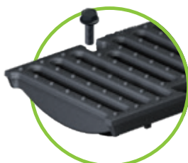
Grille passerelle en fonte ductile LF 14/150, Cl. E avec verrou fix Cl. D, boulonnée en 4 points possible uniquement dans un cadre en fonte et en plastique
