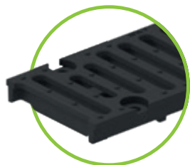
Grille en fonte ductile LF 16/120 resp. 16/220 – Cl. F boulonnée en 4 points, pour LN de 100 à 200
