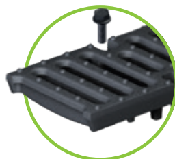
Grille passerelle en fonte ductile LF 14/100 Cl. E avec verrou fix Cl. D, boulonnée en 4 points possible uniquement dans un cadre en fonte et en plastique
