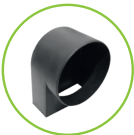
Trappe à odeurs pour avaloir (interne) DN 100/150 Installation : Insérer la trappe à odeurs à l'intérieur du avaloir et la raccorder à la canalisation par l'extérieur.
