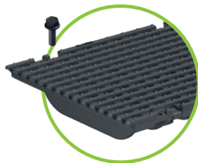
Grille à barres longitudinales en fonte ductile LM 29/13 Cl. D ou Cl. E boulonnées en 4 points
