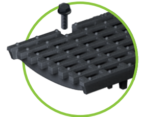
Grille à barres longitudinales en fonte ductile LM 25/13 jusqu'à la Cl. D LM 22/13 jusqu'à la Cl. E, boulonnable 4 fois possible uniquement dans un cadre en fonte
