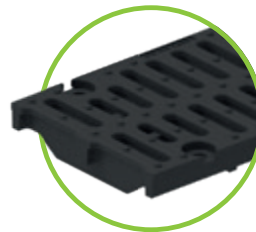
Gussrost SW 15/75 – Kl. F, 4-fach verschraubbar, für NW 150
