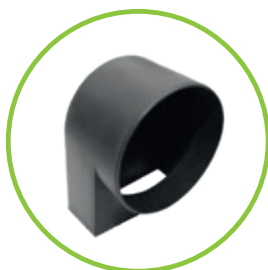
Geruchsverschluss für Sinkkasten zum Nachrüsten DN 100/150 Einbau: Den Geruchsverschluss innen im Sinkkasten einsetzen und mit dem Kanalrohr von aussen zusammenstecken.
