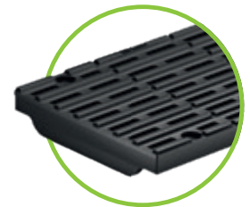
Guss-Stegrost mit Blindenleitsystem, KTL-beschichtet, SW 45/8 – Kl. E, 4-fach verschraubbar, für NW 200
