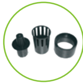
Geruchsverschluss für Ablaufbohrung be- stehend aus 3 Teilen – einsetzbar bei Rinnen mit Ablaufbohrung DN 100 – nicht zum Nachrüsten
