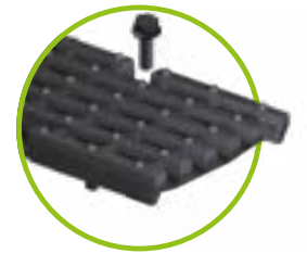
Guss-Längsstabrost MW 29/13 – NW 100 & 150 MW 25/13 – NW 150 bis Kl. D MW 22/13 – NW 150 & 200, bis Kl. E 4-fach verschraubbar nur in Gusszarge möglich
