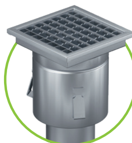
Bodenablauf einteilig 200x200 inkl. Gitterrost, Ablauf DN 110
