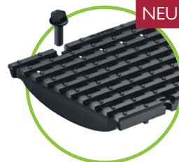
Guss-Längsstabrost MW 26/13, Kl. D 4-fach verschraubbar nur in Guss- und Kunststoffzarge
