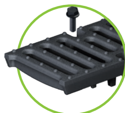
Guss-Stegrost SW 14/100 Kl. E mit fiX-Verschluss Kl. D 4-fach verschraubbar nur in Guss- und Kunststoffzarge
