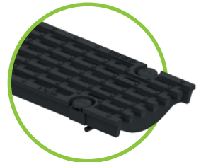
Guss-Längsstabrost MW 27/13, Kl. E für NW 100 - 200 SV oder 4-fach Verschraubung
