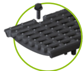
Guss-Längstabrost MW 25/13 bis Kl. D MW 22/13 bis Kl. E, 4-fach verschraubbar nur in Gusszarge möglich
