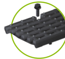
Guss-Längsstabrost MW 22/13 Kl. E 4-fach verschraubbar nur in Gusszarge möglich
