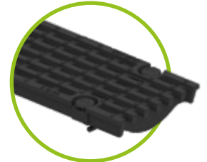
Guss-Längsstabrost MW 27/13, Kl. E für NW 100 - 200 SV oder 4-fach Verschraubung
