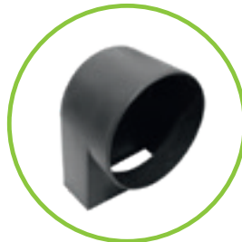
Geruchsverschluss für Sinkkasten zum Nachrüsten DN 100/150 Einbau: Den Geruchsverschluss innen im Sinkkasten einsetzen und mit dem Kanalrohr von außen zusammenstecken.
