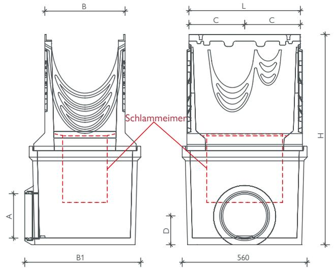
BG-FILCOTEN® pro NW 300/400 Sinkkasten, zweiteilig
