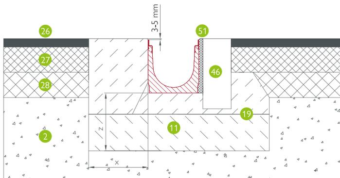
BG-FILCOTEN® tec NW 100: Asphalt - Läuferstein/Betonläufer, Kl. C
