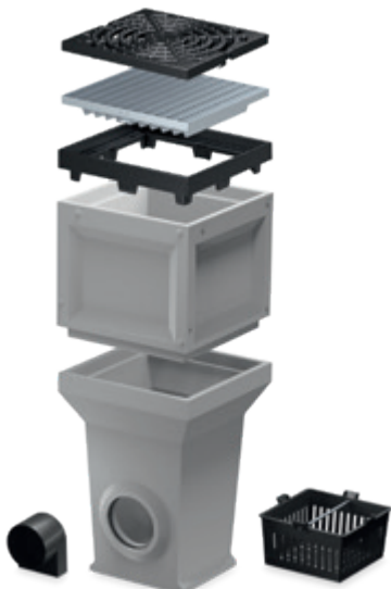
spot inkl. Gussaufsatzrahmen mit Gitterrost oder Gussrost bis Kl. B 125 inkl. Geruchsverschluss und Schlammeimer Aufsatzelement optional
